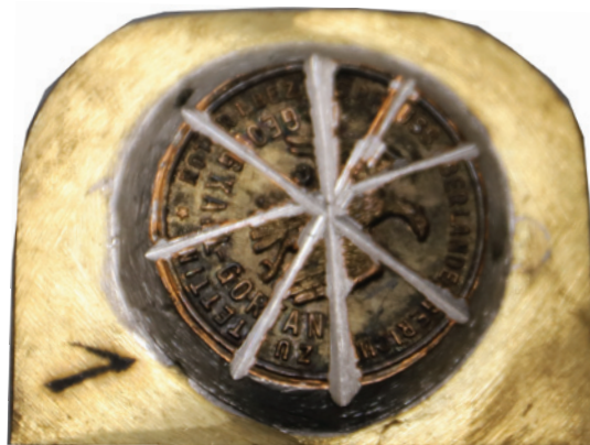
Il. 3.11. Tłok warstwowy cynkowy z płaszczem miedzianym na mosiężnej płycie (APSz, ZPiT, sygn. Tł. 837)
