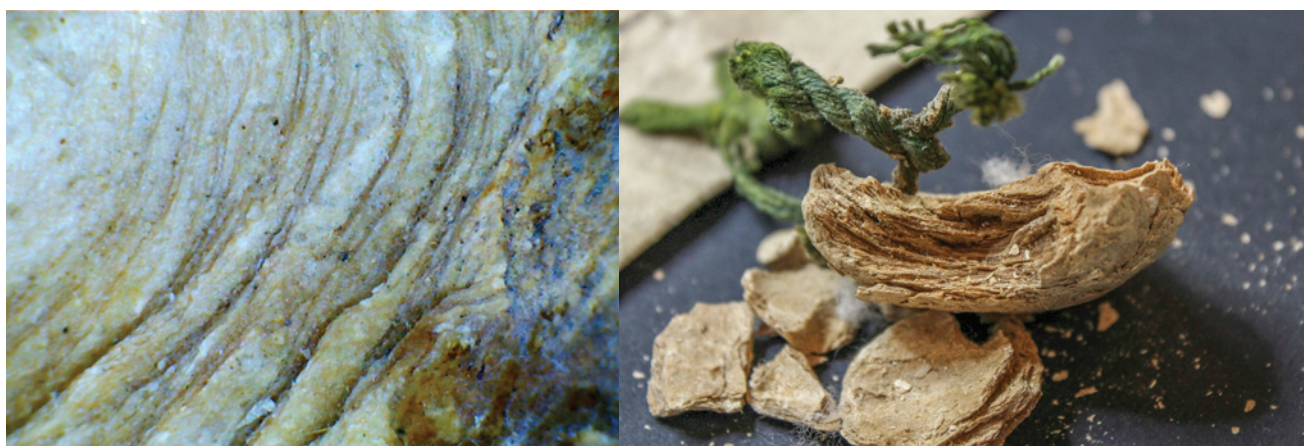
Il. 7.3. Zmiana strukturalna masy woskowej, cienkie płatki ułożone równoległe do powierzchni pieczęci (AAG, Dypl. Gn., sygn. 87; zdj. Ivona Jablonskaja)
